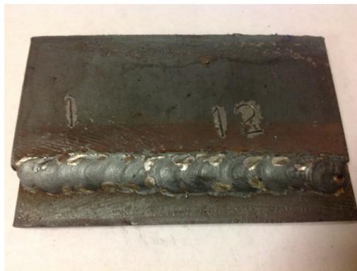
*Figure 2. Weld test coupon.*
